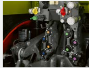
Druckluftbremsanlage mit Lufttrockner
